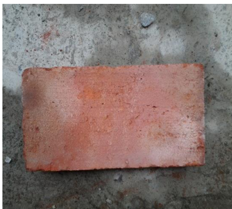
Gambar 5.3. : Bentuk batu bata campuran abu sekam setelah proses pembakaran
