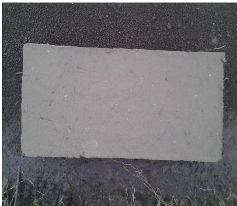
Gambar 5.1. : Bentuk batu bata campuran abu sekam pada saat proses pengeringan
