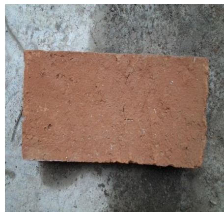
Gambar 5.4. : Bentuk batu bata campuran ampas tebu setelah proses pembakaran
