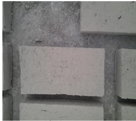
Gambar 5.2. : Bentuk batu bata campuran ampas tebu pada saat proses pengeringan
