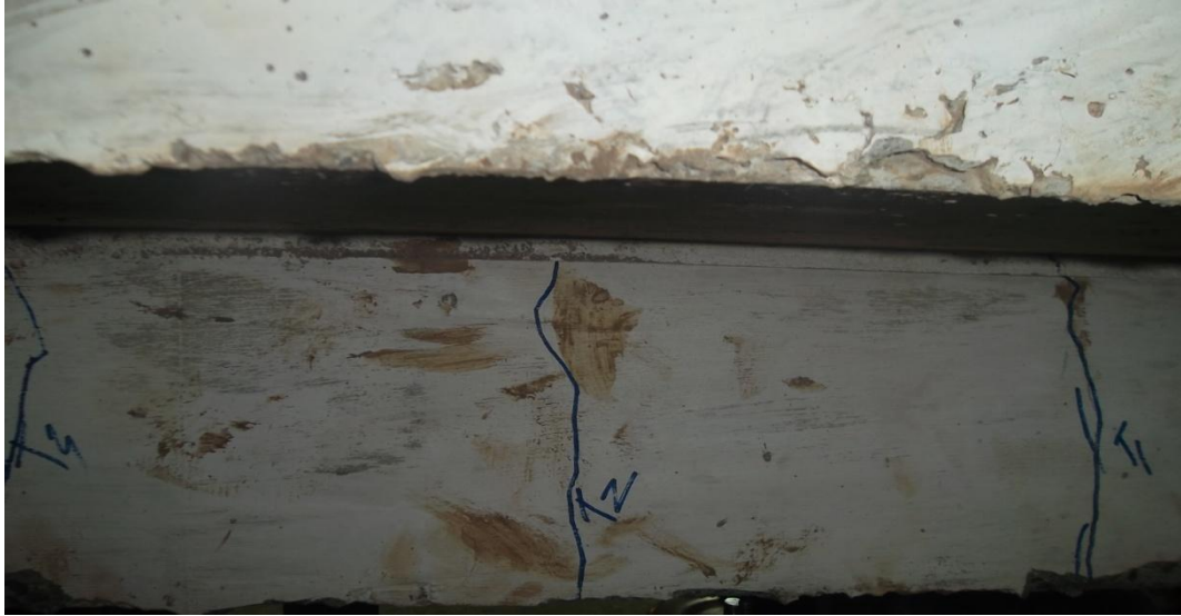
Gambar 4.9 Pola Retak Balok T Tanpa Sambungan Beton dan Tulangan C (BTS-C)
