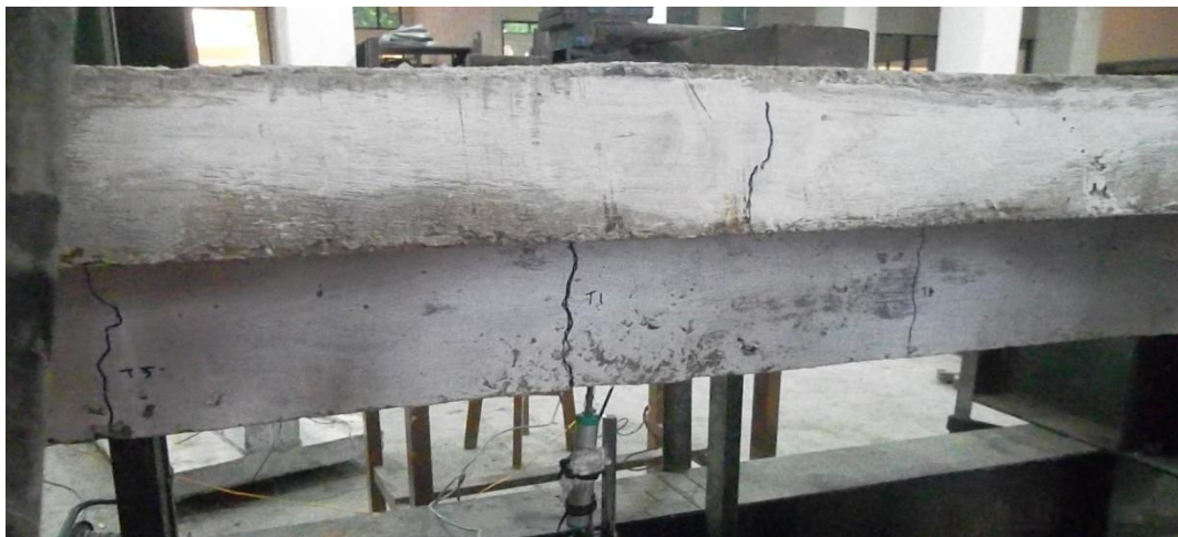
Gambar 4.40 Pola Retak Balok Tanpa Sambungan (BTS)-A
