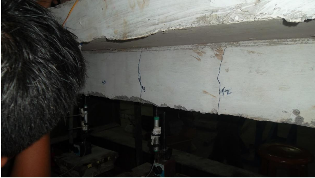
Gambar 4.44 Pola retak balok dengan jarak sambungan 1/4 bentang (B-1/4B)
