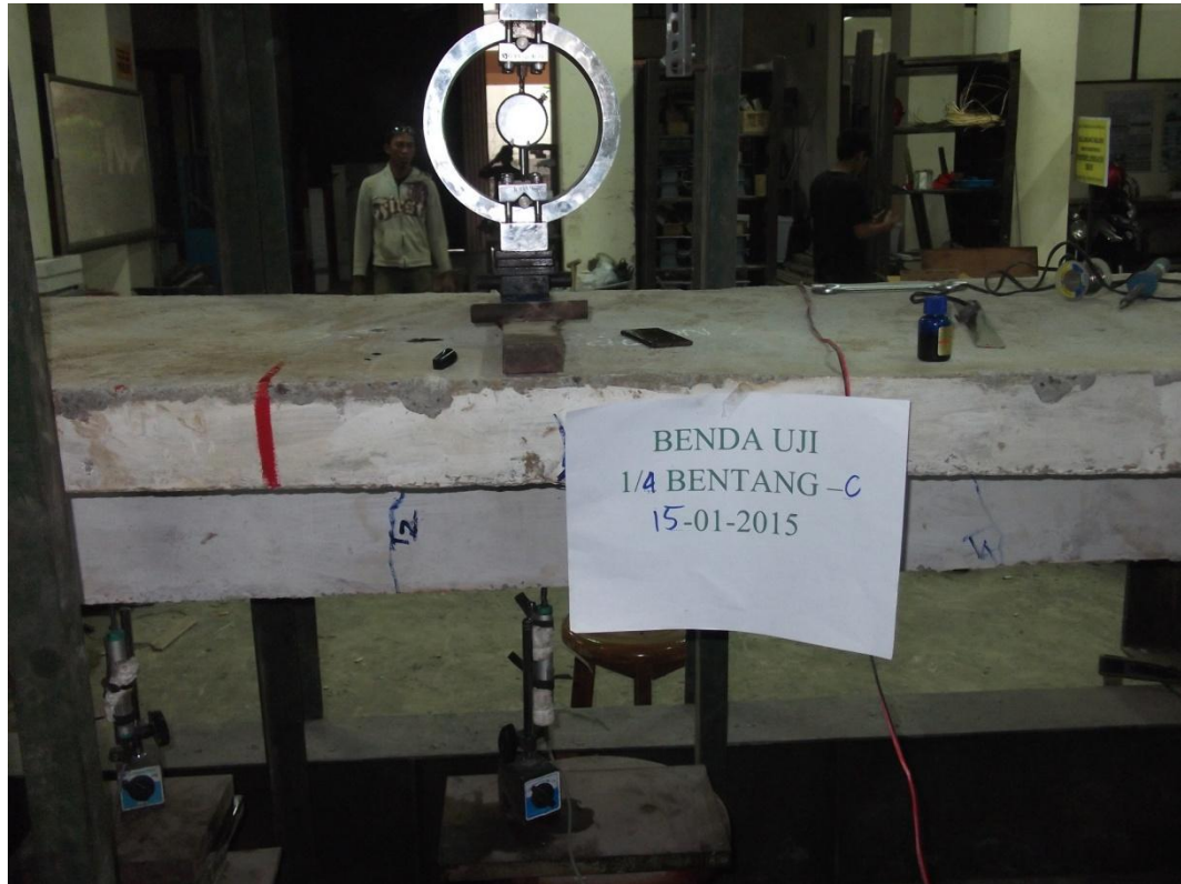
Gambar 4.19 Pengujian Kuat Lentur Balok Dengan Jarak Sambungan (1/4) B
