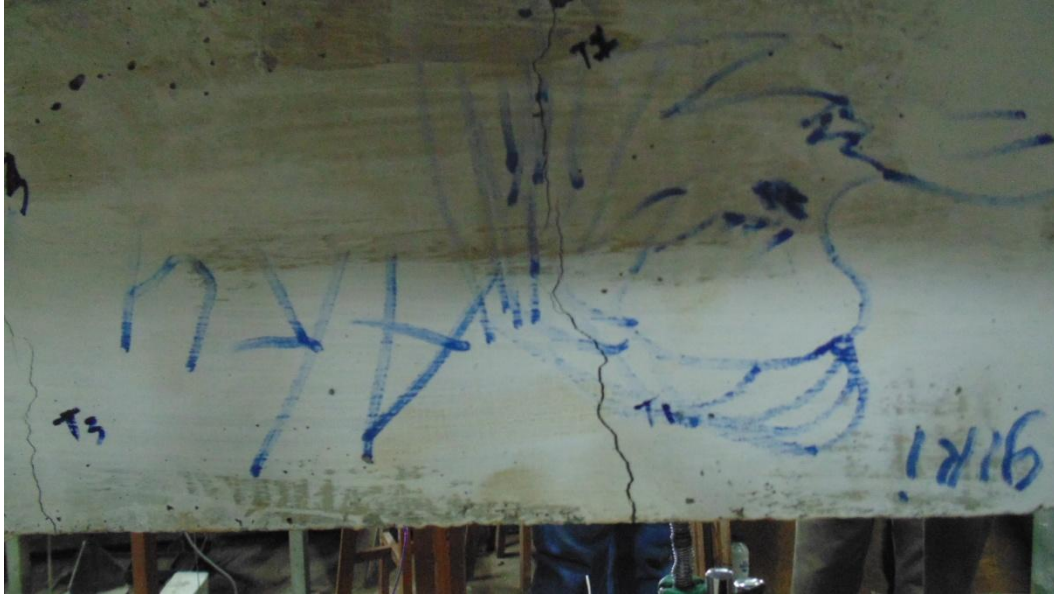
Gambar 4.43 Pola Retak Balok Dengan Jarak Sambungan \frac{1}{4} Bentang (B-1/4 A)
