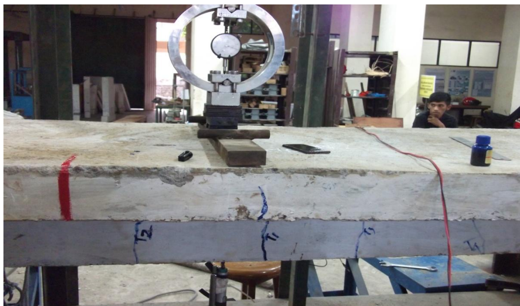
Gambar 4.45 Pola retak balok dengan jarak sambungan 1/4 bentang (B-1/4C)
