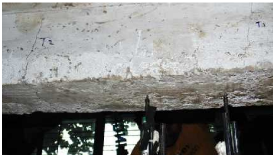
Gambar 4.12 Pola Retak Pada Balok T dengan Jarak Sambungan 1/3 Bentang C ( 1/3-C)
