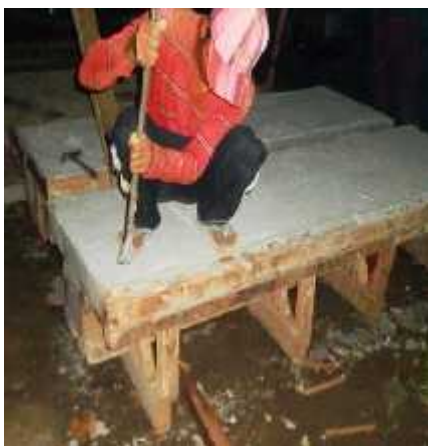
Pembongkaran benda uji
