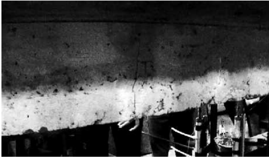
Gambar 4.8 Pola Retak Pada Balok T dengan Jarak Sambungan 1/3 Bentang A ( 1/3-A )
