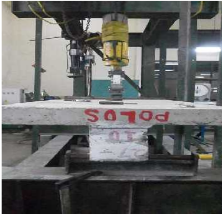
Gambar 4.1 Pengujian Kuat lentur balok tanpa sambunganA (BTS-A)
