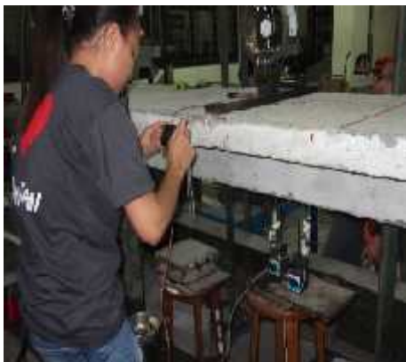
Pengujian Rekam Retak
