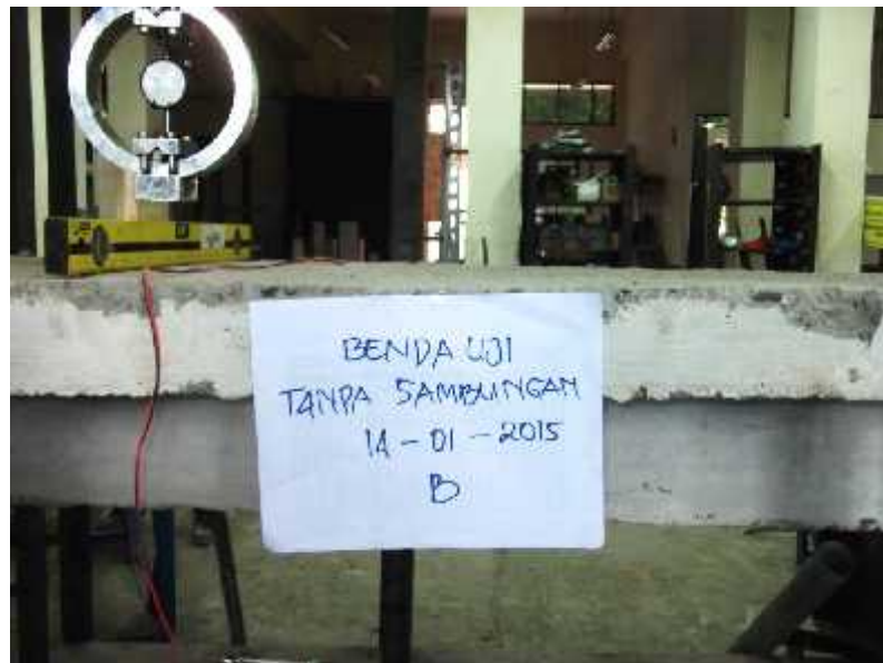
Gambar 4.3 Pengujian Kuat lentur balok tanpa sambungan B (BTS-B)
