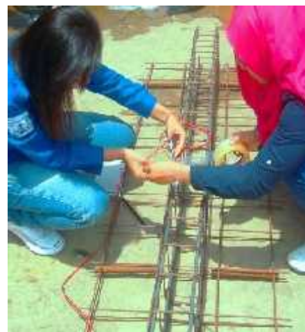
Pemasangan Strain Gauges
