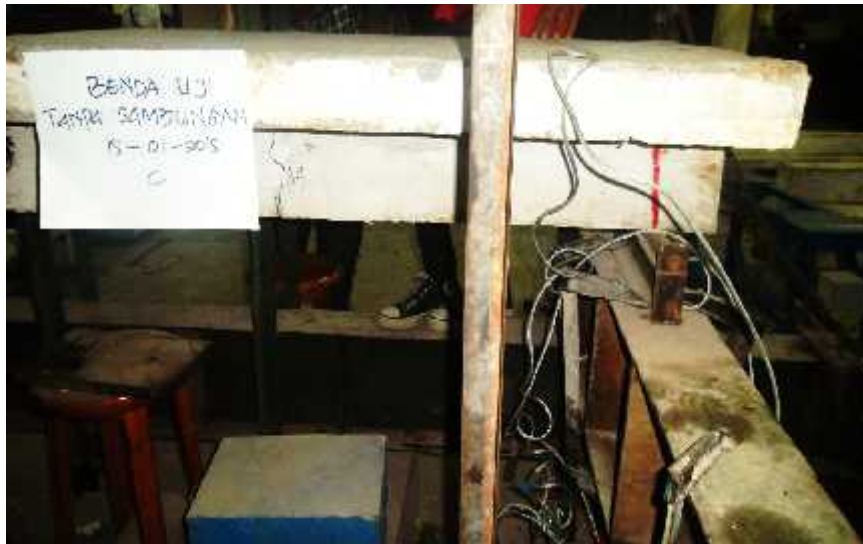
Gambar 4.5 Pengujian Benda Uji Balok T Tanpa Sambungan C (BTS-C)
