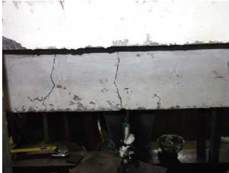
Gambar 4.10 Pola Retak Pada Balok T dengan Jarak Sambungan 1/3 Bentang B ( 1/3-B )
