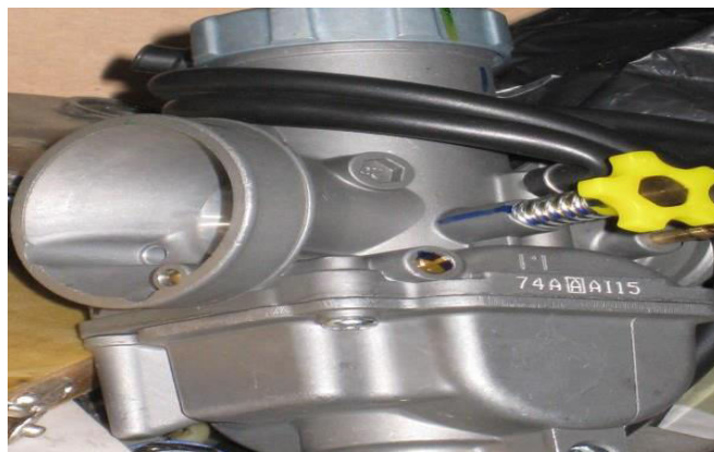
Gambar 2.19. Karburator RX KING Ukuran 26 mm (sumber:dokementasi sendiri)
