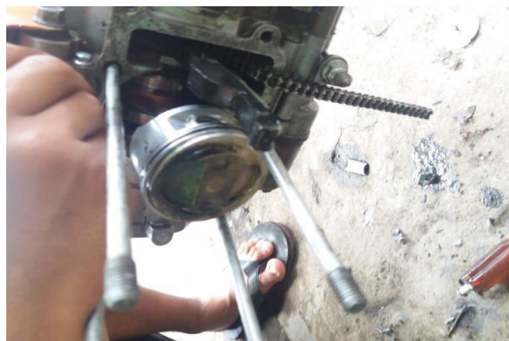
Gambar 2.17.Piston ukuran 50 mm (sumber: dokumentasi sendiri)
