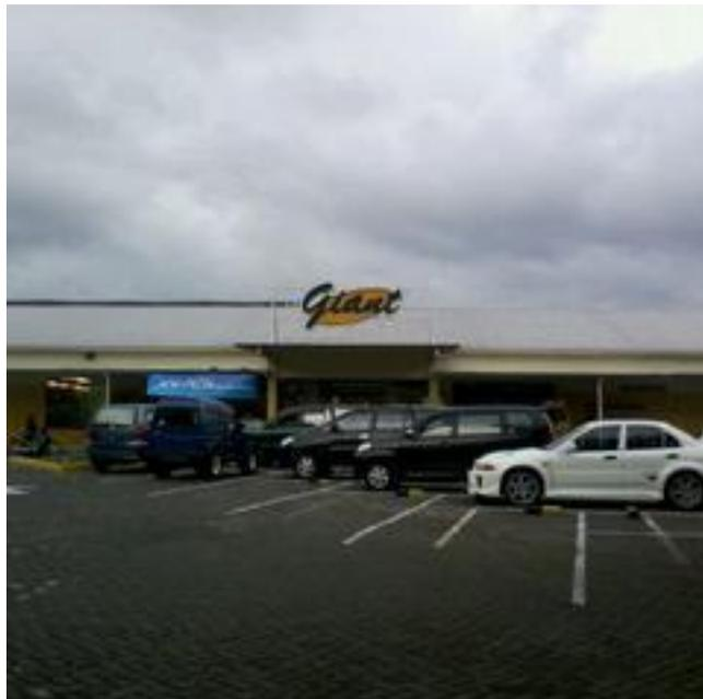
Gambar 2.15 Contoh Penerapan Pola Parkir  $45^{\circ}$  untuk kendaraan parkir roda 4
