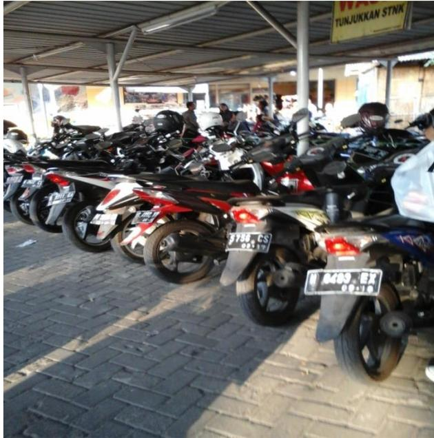
Gambar 2.14 Contoh Penerapan Pola Parkir  $90^{\circ}$  untuk kendaraan parkir roda 2
