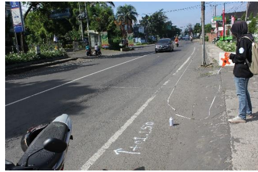
Gambar F25 Penggunaan Roll Meter pada Pengukuran Segmen
