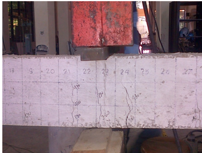
Gambar 4.8 Pola retak balok tanpa sambungan (BTS)-C
