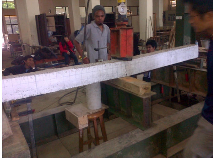
Gambar 4.1 Pengujian Kuat lentur balok tanpa sambungan A (BTS-A)
