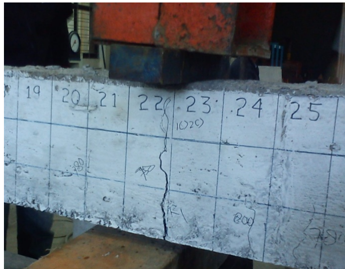
Gambar 4.6 Pola retak balok tanpa sambungan (BTS)-A
