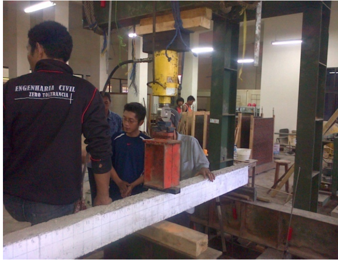
Gambar 4.2 Pengujian Kuat lentur balok tanpa sambungan B (BTS-B)
