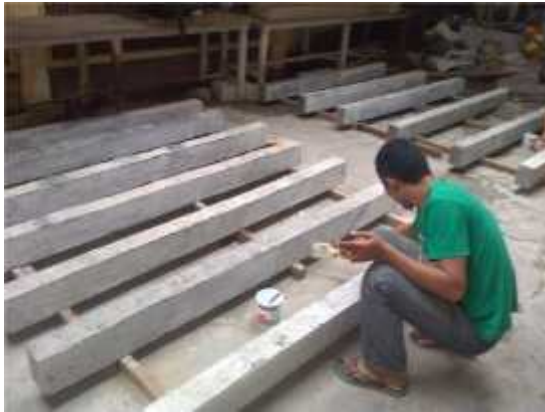
Pengecatan permukaan benda uji
