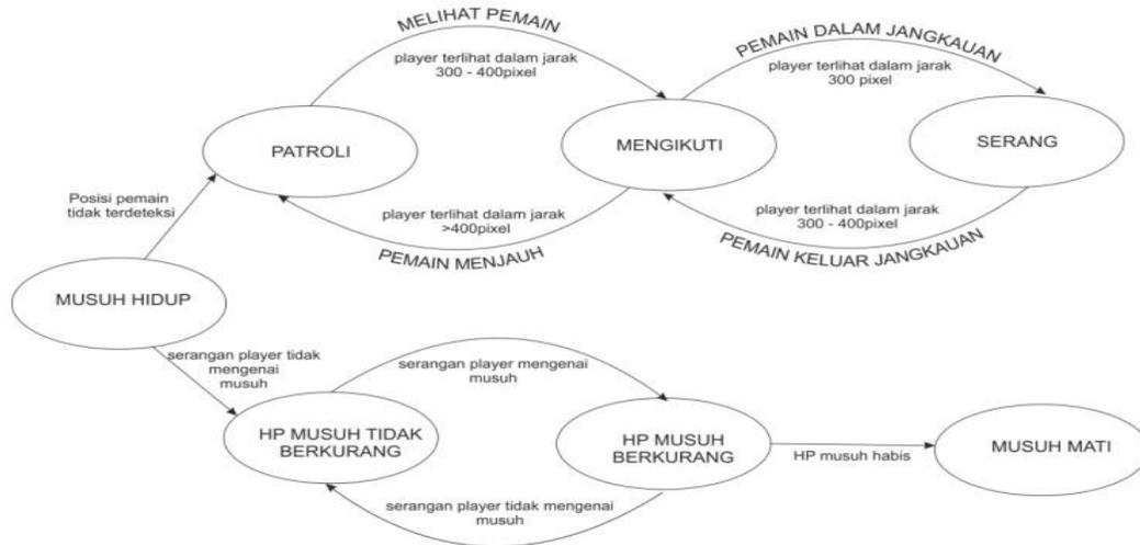
Gambar 3.37 Diagram Finite State Machine pada Musuh
