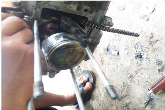
Gambar 2.17. Piston ukuran 50 mm
