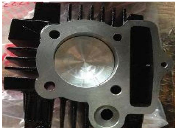
Blok standar dengan diameter piston 50 mm
