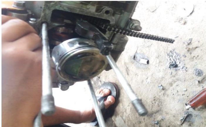
Gambar 4.1 Piston ukuran 50 mm
