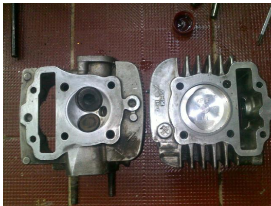
Blok setelah diganti dengan piston 52,4 mm
