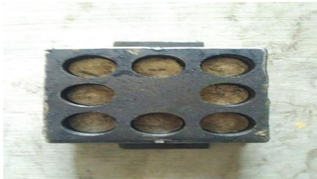
Gambar 3.5 Rangkaian Dies Cetakan Briket
