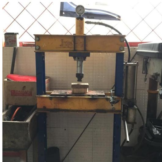
Gambar 3.4 Alat Pengepres
