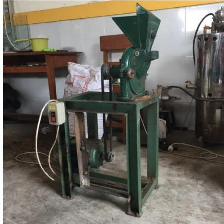
Gambar 3.3 Mesin Penggiling
