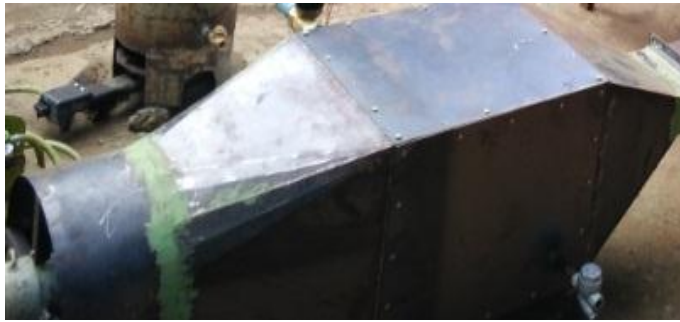
Gambar 3.8 Heat Exchanger (Sumber : foto sendiri)
