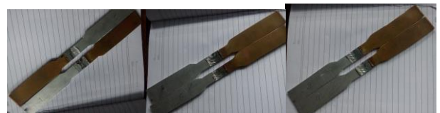
Gambar 3.28 Spesimen Uji Tarik ASTM 8M-09
