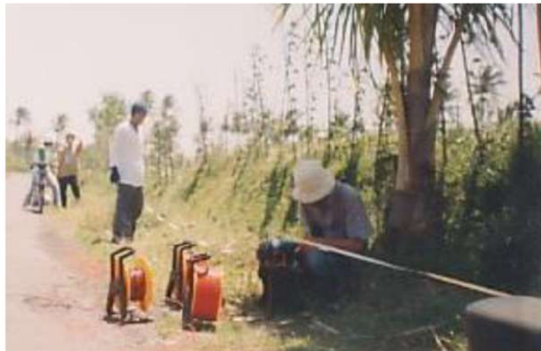
Gambar 11. Pengukuran Tahanan Jenis Tanah (Lokasi: 694519, 9091148; Waktu: September 2004)
