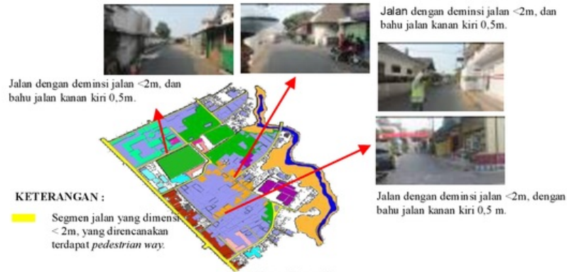
Gambar 8 Peta dan foto kondisi dan lokasi segmen-segmen jalan
