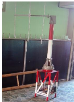
Gambar 7. Konfigurasi Antena Pada Rotator
