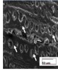
**Gambar 6. Foto SEM Mikrostruktur Serat Ijuk Dengan *Alkali Treatment* 2% NaOH**
