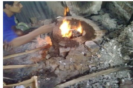
Gambar 10 Proses peleburan aluminium tembaga(Sumber : Dokumentasi)
