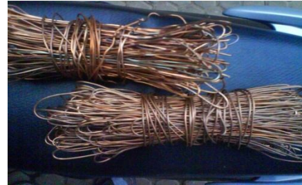
Gambar 6 kawat tembaga sebagai bahan paduan utama pembuatan spesimen
