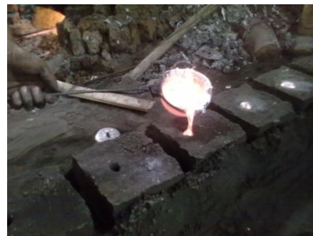
Gambar 12 Proses penuangan logam cair (Sumber : Dokumentasi)
