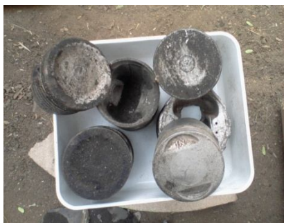
Gambar 5 Piston sebagai bahan baku (Al) Spesimen
