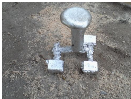
Gambar 14 Proses pendinginan udara (Sumber : Dokumentasi)
