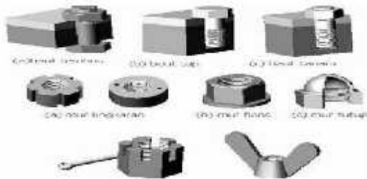
Gambar 2. Macam-macam Baut dan Mur Sumber : Sularso, 2008
