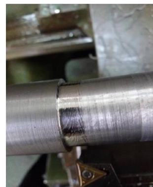
Gambar 6. Hasil Pemotongan Pada Kedalaman Potong 1,8 mm, Terjadi Chatter
