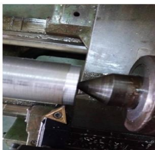
Gambar 3. Hasil Pemotongan Pada Kedalaman Potong 0,2 mm
