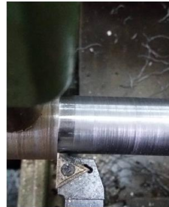
Gambar 10. Hasil Pemotongan Pada Kedalaman Potong 3,0 mm, Terjadi Chatter
