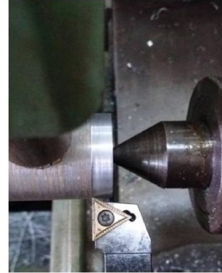
Gambar 9. Hasil Pemotongan Pada Kedalaman Potong 0,2 mm
