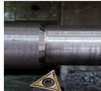
Gambar 4. Hasil Pemotongan Pada Edalaman Potong 2,2 mm, Terjadi Chatter
