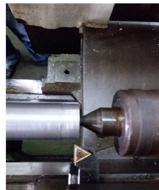
Gambar 5. Hasil Pemotongan Pada Kedalaman Potong 0,2 mm
