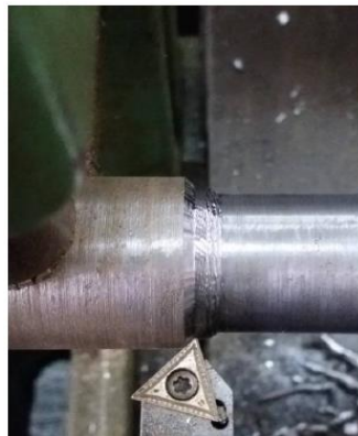
Gambar 8. Hasil Pemotongan Pada Kedalaman Potong 3,2 mm, Terjadi Chatter
