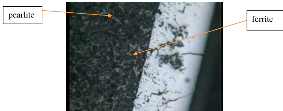
Gambar 4 Struktur mikro hasil uji mikroskop optik perlakuan nitridisasi tanpa serbuk alumina Baja Hard khrom
