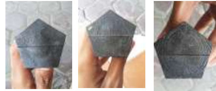
Gambar 7. Cacat warping pada produk tekanan 80 Bar
