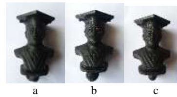
Gambar 6. Produk dengan tekanan injection molding a)80, b) 75, c) 70 Bar
