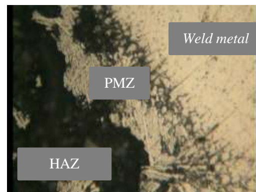
Gambar 24 Struktur mikro pada base metal, haz, dan weld metal (Perbesaran 400x)
