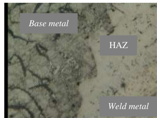
Gambar 24 Struktur mikro pada base metal, haz, dan weld metal (Perbesaran 400x)
