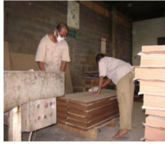
Gambar 1. Sikap Kerja Pengolesan Lem pada Proses Laminasi
