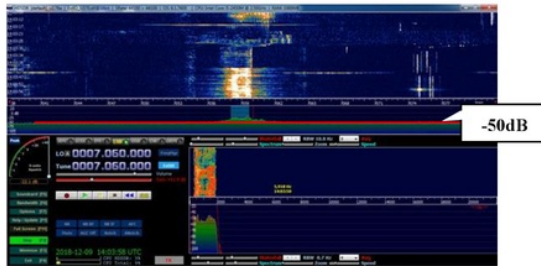
Gambar 9. Pengukuran Noise dengan IC 4052
