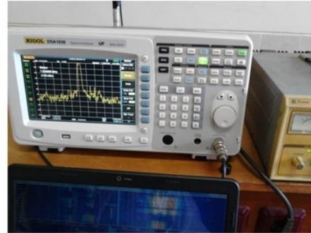
Gambar 11. Pengukuran Transmit pada Frekuensi 7,035 MHz
