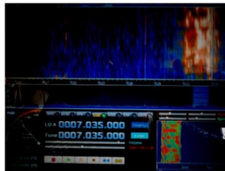
Gambar 12. Pengukuran Transmit HDSDR pada Frekuensi 7,035 MHz
