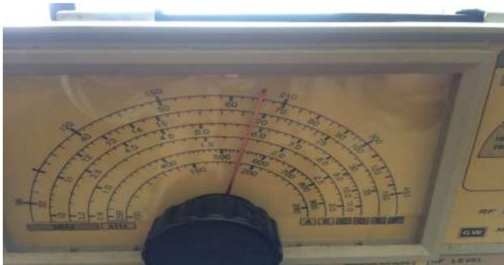
Gambar 4.7 Frekuensi range pada frekuensi 6.5 MHz pada pengujian rangkaian band pass filter
