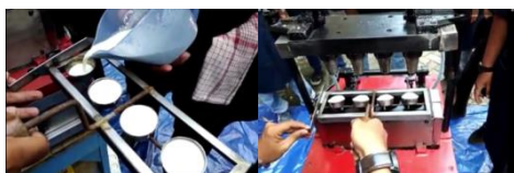
Gambar 9 Proses penuangan adonan cone es krim
