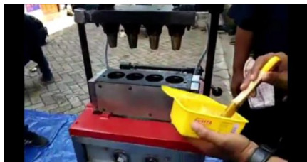
Gambar 8 Proses pengolesan margarin ke cone mould
