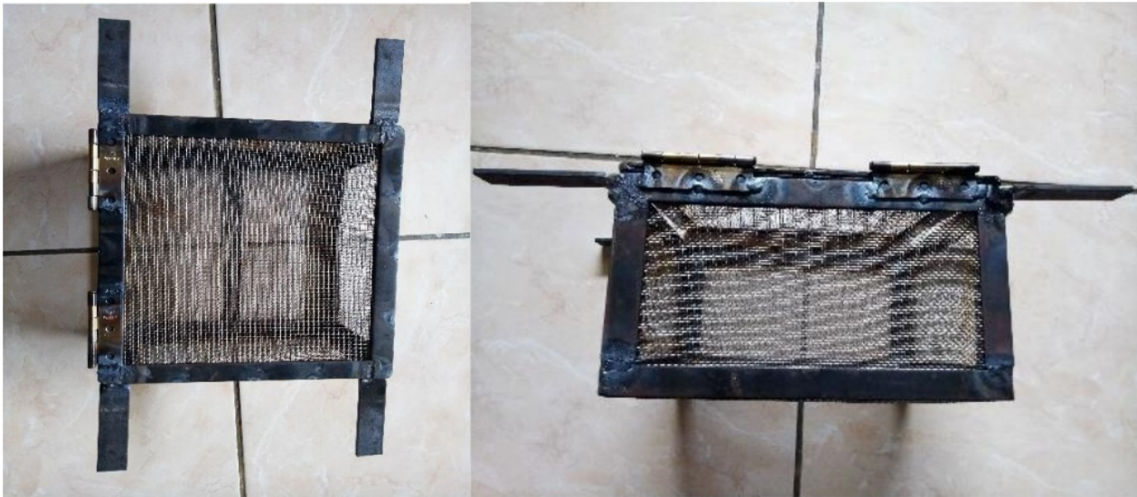
Gambar 1 : kotak yang terbuat dari plat besi dan kawat Weirmesh
