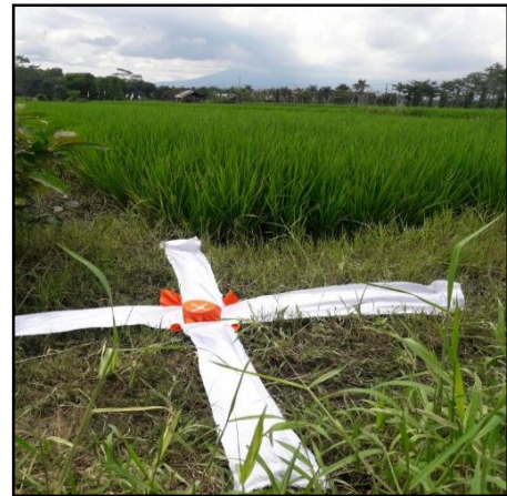
Gambar 5. Ground Control Point (Subakti, 2017)
