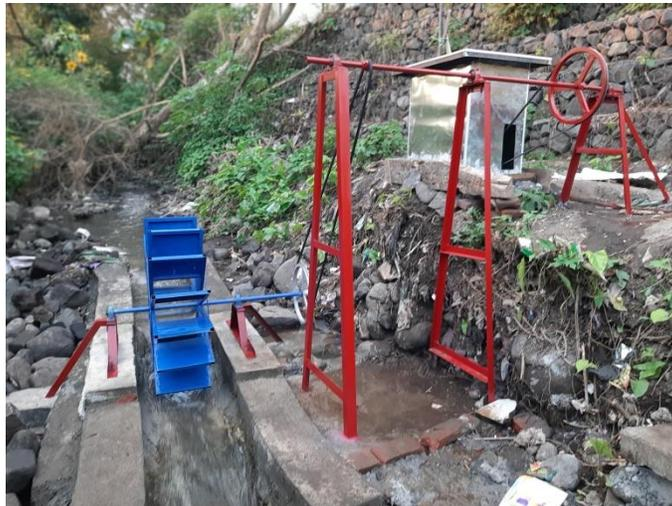
Gambar 2.1 Pembangkit Listrik Tenaga Mikro Hidro
