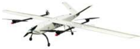
Gambar 2.4 Contoh wahana UAV, Pesawat Survei Cessna Nimbus VTOL V2 (avionsinsurance Dokumentasi)
