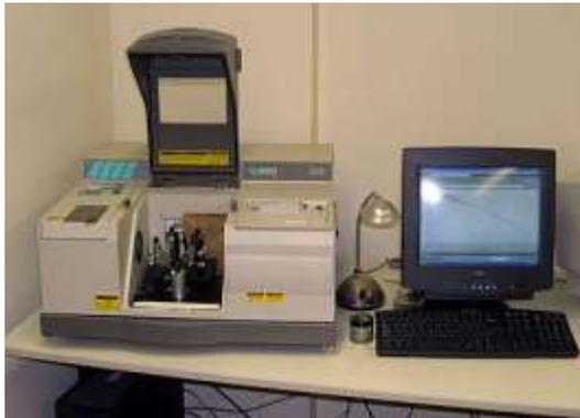
Gambar 3.11 Mesin Uji FTIR
