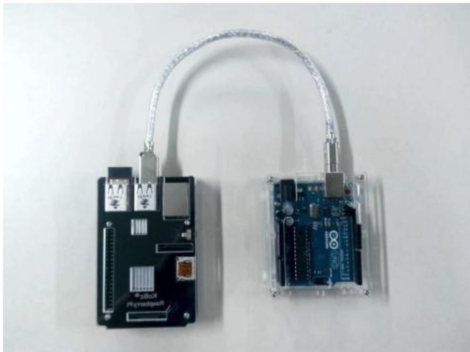
Gambar 3.4 Komunikasi Arduino dan Raspberry
