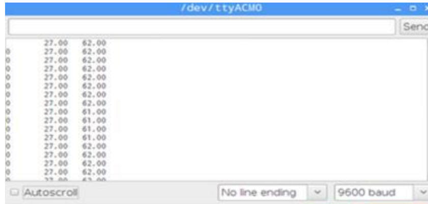
Gambar 4.8 Hasil data sensor PIR dan DHT11 pada Arduino
