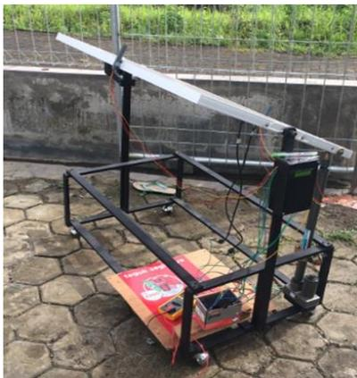
Gambar 4.11 Hasil Sistem Tracker Untuk Pembangkit Listrik Tenaga Surya
