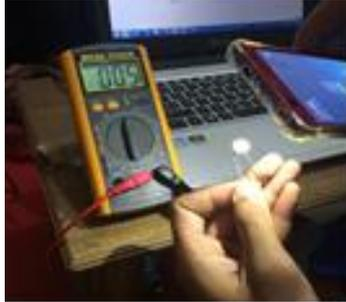
Gambar 4.1 Hasil Pengujian Resistansi Sensor Cahaya
