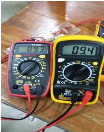
Gambar 14. Hasil percobaan tanpa beban dengan rpm 900 yang dapat menghasilkan tegangan sebesar 9,4 volt
