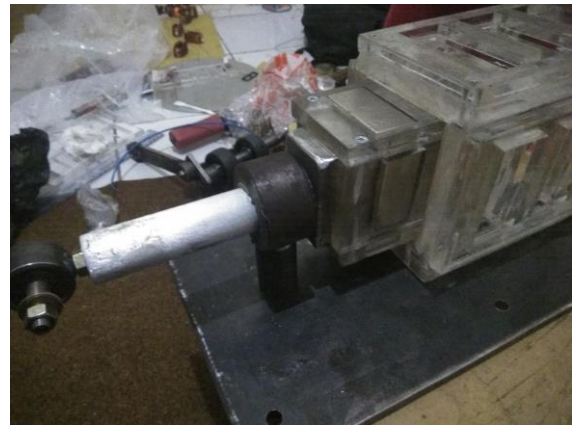
Gambar 10. Pemasangan translator rotor ke dalam rumah stator
