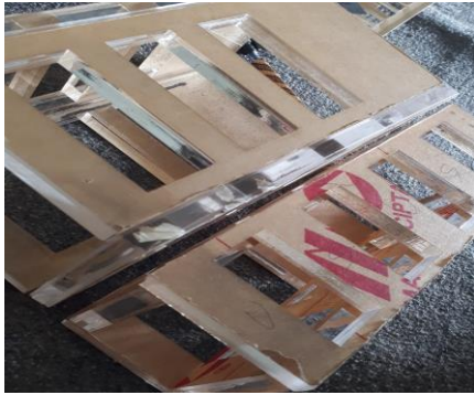
Gambar 7. Akrilik sebagai rumah stator dan rotor yang sudah di cutting lazer .
