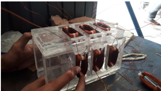
Gambar 9. Memasang kumparan ke akrilik sebagai stator
