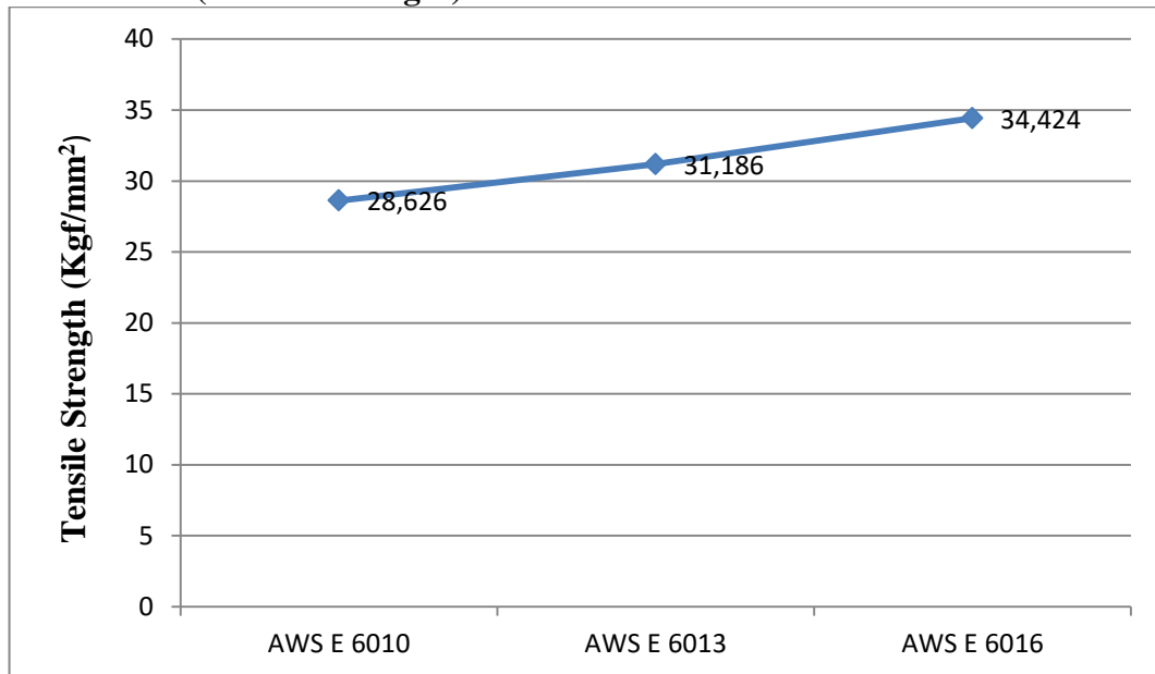
Grafik 4.1 Hubungan Variasi Elektroda Terhadap Nilai T.S (Tensile Strength)
