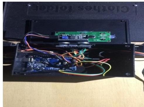
Gambar 3.2 Kotak Pengontrol Sistem
