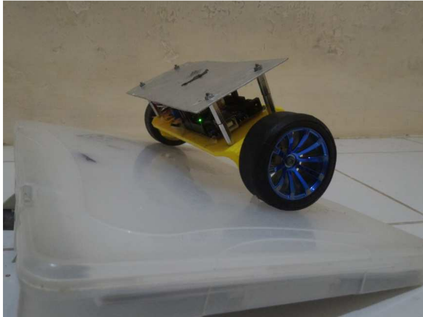
Gambar 4. 8 Robot Keseimbangan Beroda Dua Pada Medan Kemiringan 11 Derajat
