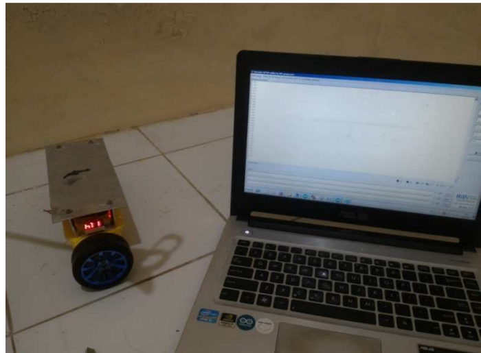
Gambar 4. 3 Pembacaan Serial Data Bluetooth Pada Software Hercules
