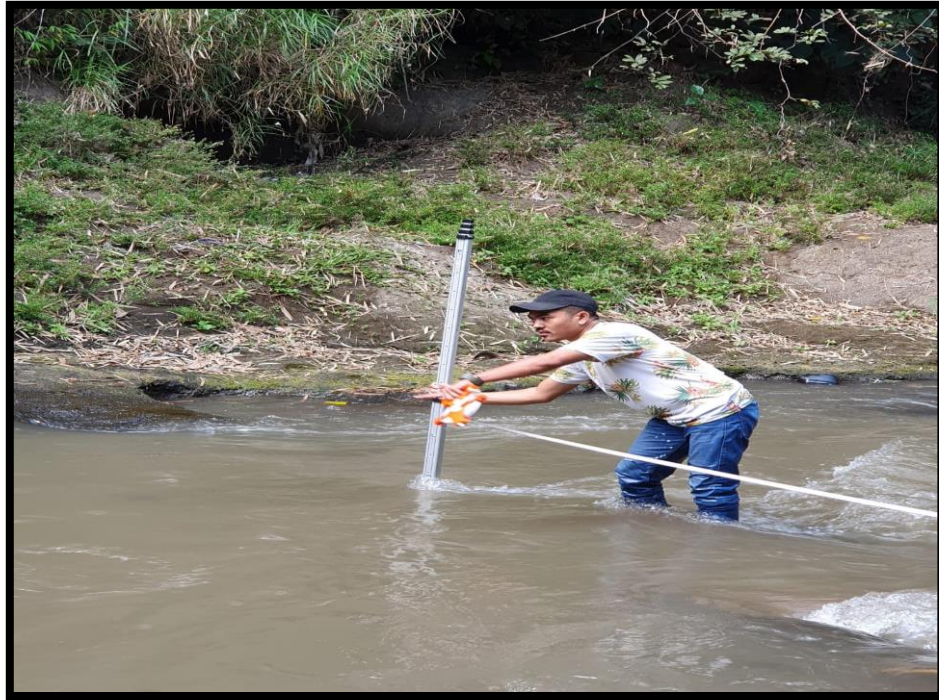
Gambar pengukuran kedalaman menggunakan rambu berskala
