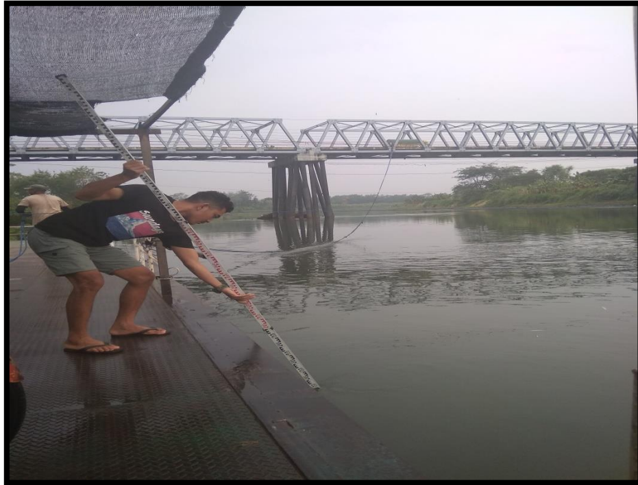
Gambar pengukuran kedalaman menggunakan media perahu
