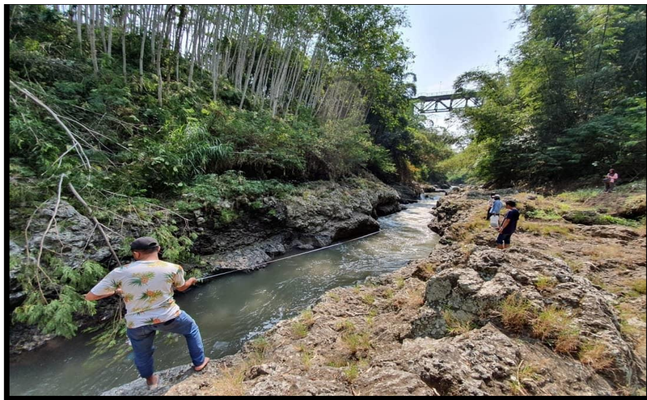
Gambar pengukuran panjang lintasan menggunakan meteran untuk pengukuran kecepatan arus
