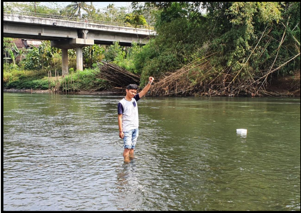
Gambar gabus sampai pada panjang lintasan yang telah di ukur sebelumnya
