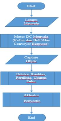
Gambar 3.2 Flowchart Proses Deteksi dan Sortir Keseluruhan
