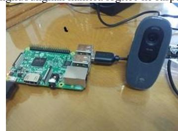
Gambar 3.2 Kamera USB Logitec ke Raspberry Pi
