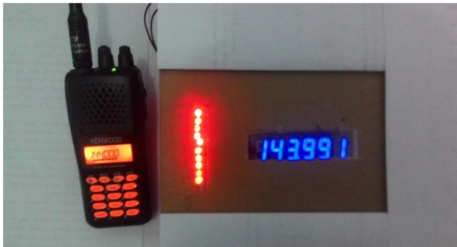
Gambar 4. 4 Tampilan frekuensi dan strength meter di HT bagian receiver , dan tampilan di alat pengukur frekuensi 144 mhz
