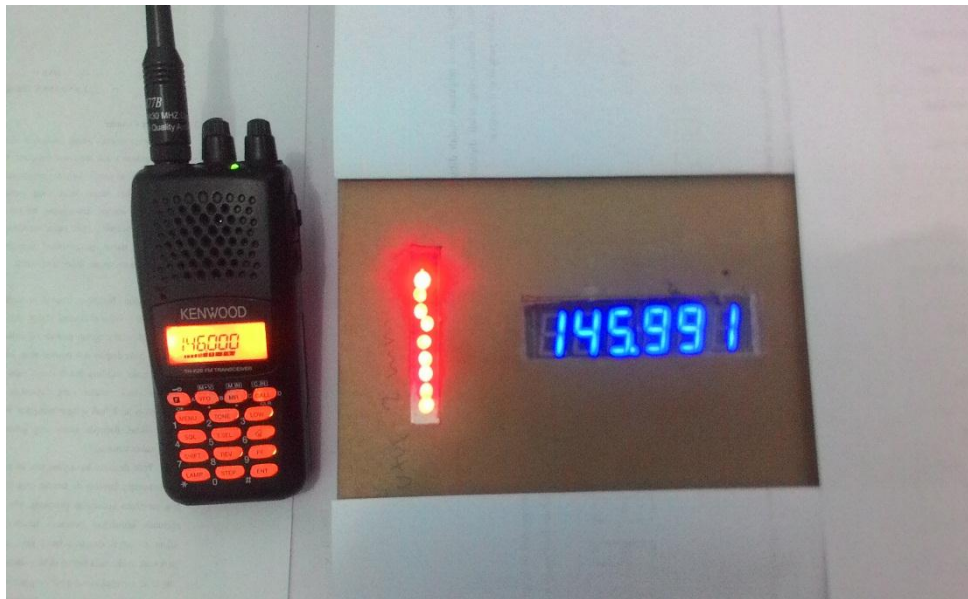
Gambar 4. 5 Tampilan frekuensi dan strength meter di HT bagian receiver , dan tampilan di alat pengukur frekuensi 146 mhz
