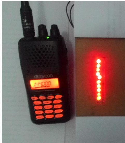
Gambar 4. 8 Pengujian Field Strength Meter Frekuensi 144 Mhz
