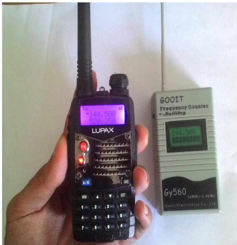
Gambar 4. 1 Pengujian Transmitter HT 144.500 Mhz dengan frekuensi counter
