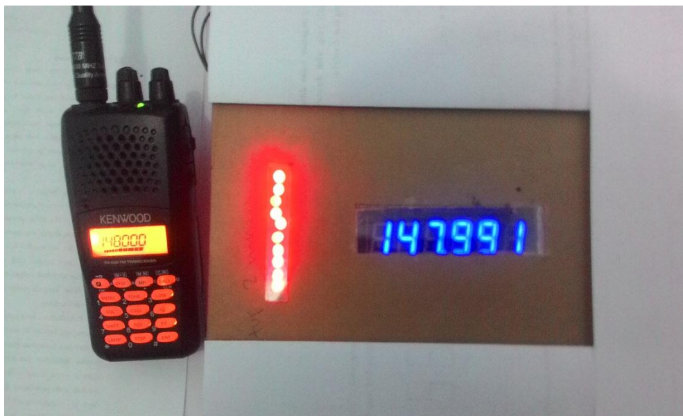
Gambar 4. 6 Tampilan frekuensi dan strength meter di HT bagian receiver , dan tampilan di alat pengukur frekuensi 148 mhz.
