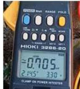
Gambar 18. Tampilan Arus Gangguan yang Melebihi Kapasitas *Circuit Breaker*
