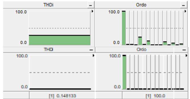
Gambar 9. Harmonisa Arus pada Panel Produksi1 (MCCBALL)sebelum dan sesudah pemasangan filter pasif
