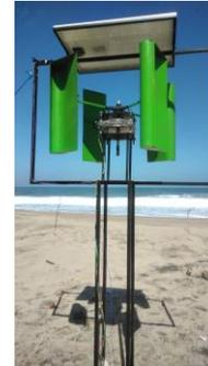
Gambar 3.10 Konstruksi Kombinasi PLTB - PV
