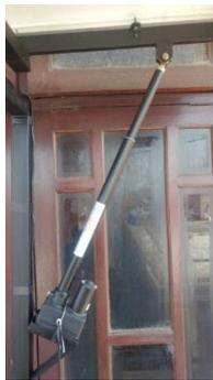
**Gambar 2.4** Aktuator linier
