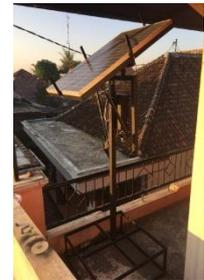
**Gambar 4.5** Hasil Perencanaan dan perancangan *dual axis solar tracker*
