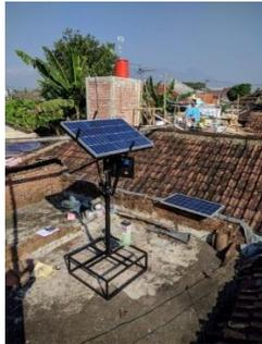
Gambar 4.12 Pengujian Alat Dengan Tracking system dan tanpa Tracking system dalam waktu yg sama
