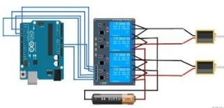
**Gambar 3.9** Pengkabelan Arduino uno dengan Aktuator Linier
