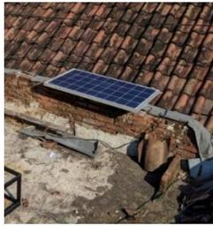
Gambar 4.11 Pengujian Alat Tanpa Tracking sistem
