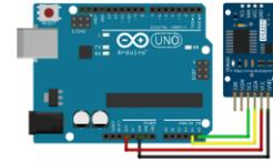
Gambar 3.3 Perancangan Rangkaian RTC
