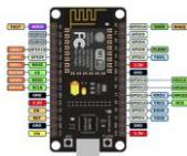
Gambar 2.11 Skematik Posisi Pin Node MCU
