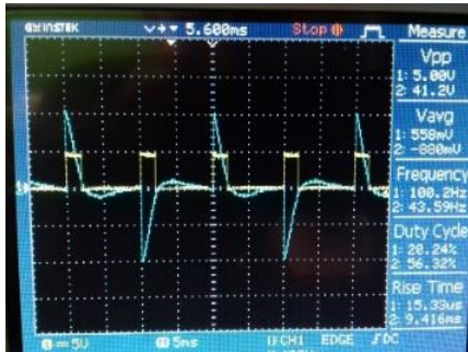
Gambar 4.9 Bentuk Gelombang Dengan Duty Cycle 20%
