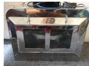
Gambar 3.2 Kotak Pengering Buah Kopi
