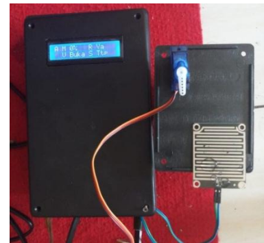
Gambar 33 Raindrop Sensor Mendeteksi Hujan
