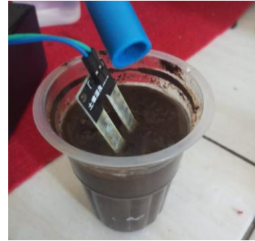
Gambar 32 Kelembaban Tanah 52% Penyiraman Berhenti
