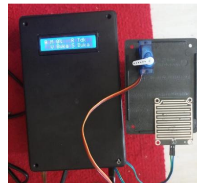
Gambar 34 Raindrop Sensor Tidak Mendeteksi Hujan
