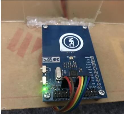
Gambar 15. Pengujian NFC tag Terhadap NFC reader PN532
