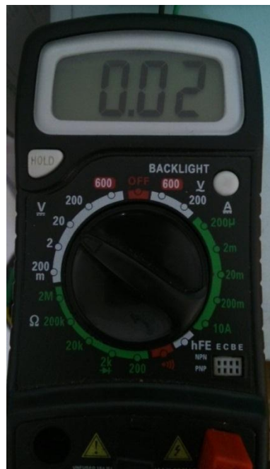
Gambar 4.5 Hasil Pengujian Output Tegangan Pin Digital Arduino Mega 2560 pada Keadaan Logika Low
