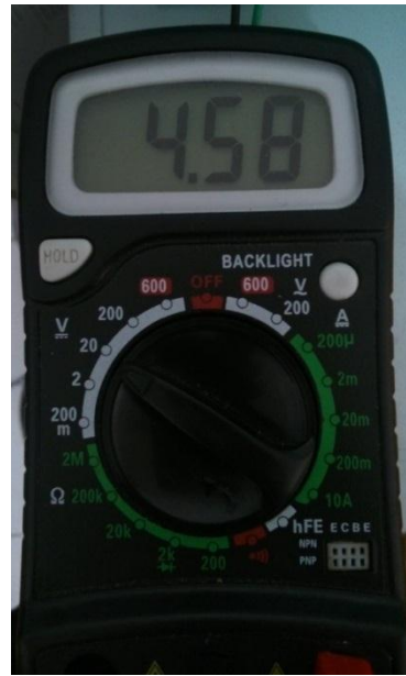
Gambar 4.4 Hasil Pengujian Output Tegangan Pin Digital Arduino Mega 2560 pada Keadaan Logika High
