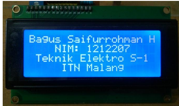
Gambar 4.6 Hasil Pengujian Modul LCD 20x4
