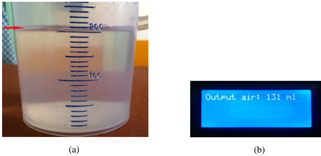
Gambar 4.2 Hasil Pengujian 1 210ml Sensor Water Flow pada (a) Gelas Ukur dan (b) Tampilan LCD
